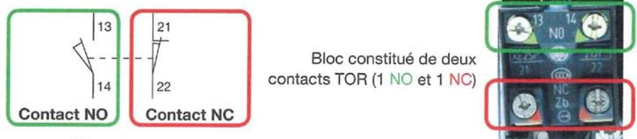
Électriquement, les contacts changent d'état lorsque le dispositif d'attaque détecte un objet.
