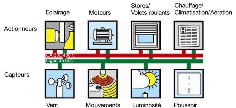
Les capteurs et les actionneurs sont sélectionnés en fonction de l'application requise et intègrent un module d'application avec le logiciel correspondant. Les logiciels d'application font partie intégrante de la base de données des produits Schneider Electric et sont installés dans les appareils connectés à l'aide du logiciel de planification et de mise en service ETS.
