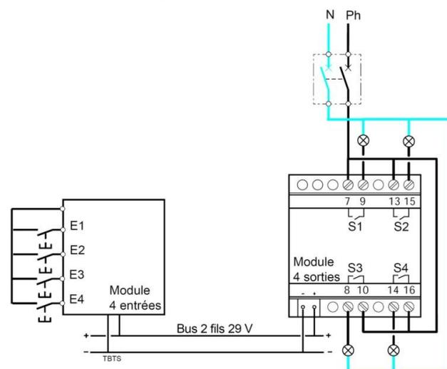
Le circuit de commande relie entre eux l'ensemble des modules d'entrée auxquels sont raccordés les organes de commandes et les modules de sortie. Après le câblage, il suffira de programmer l'ensemble de l'installation suivant le fonctionnement souhaité.
