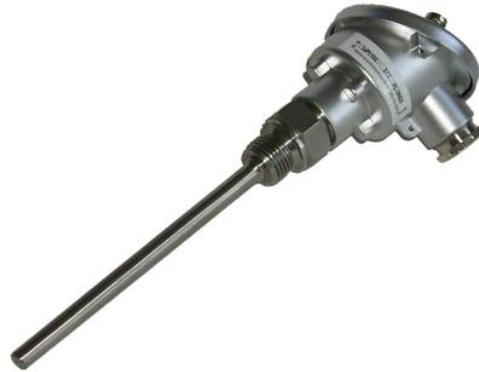
**La sonde PT100** est une résistance en platine (PT) variable en fonction de température du milieu ( $100\Omega$  à  $0^\circ\text{C}$ ).
