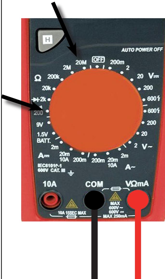
Se positionner sur 200, calibre de mesure de résistance minimum, puis monter les calibres , 2K, 20K, 200K, 2M, 20M (maximum) de manière à avoir une valeur cohérente.
