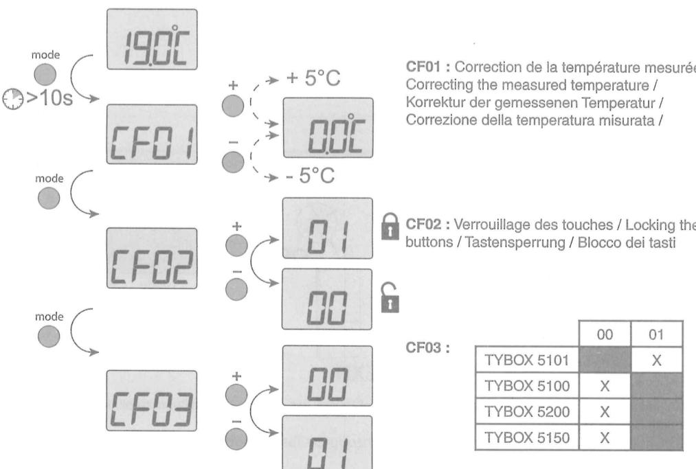
**CF01 :** Correction de la température mesurée / Correcting the measured temperature / Korrektur der gemessenen Temperatur / Correzione della temperatura misurata /
