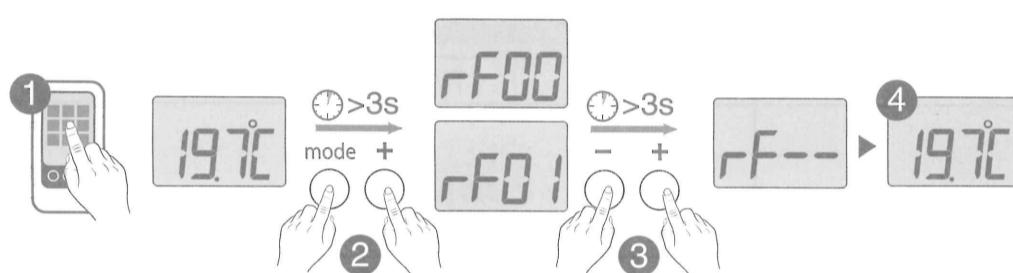
**FR** ① Mettez le gestionnaire d'énergie en mode «Association d'un capteur de type sonde d'ambiance» (voir sa notice). ② Sur le TYBOX 5101, appuyez simultanément 3 secondes sur les touches **mode** et **+** jusqu'à afficher rF01 (rF00 si TYBOX 5101 utilisé seul). ③ Appuyez simultanément 3 secondes sur les touches **+** et **-**. L'écran affiche rF--. ④ Sortie automatique du mode.
